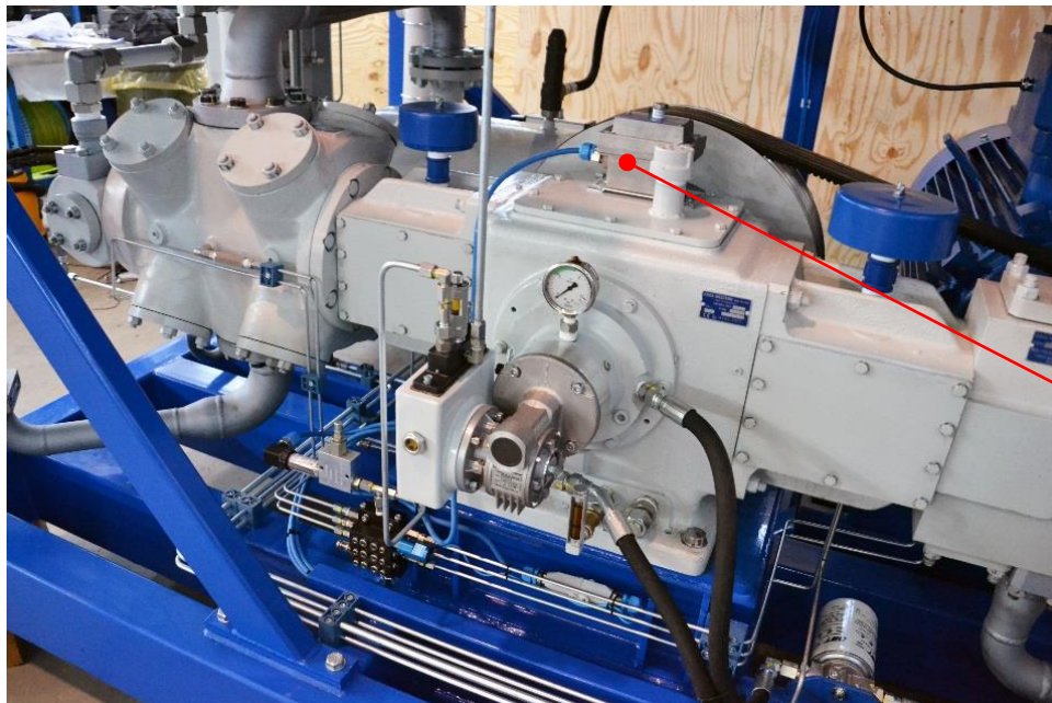
Рис. 17 Расположение устройства контроля вибрации на раме компрессора
